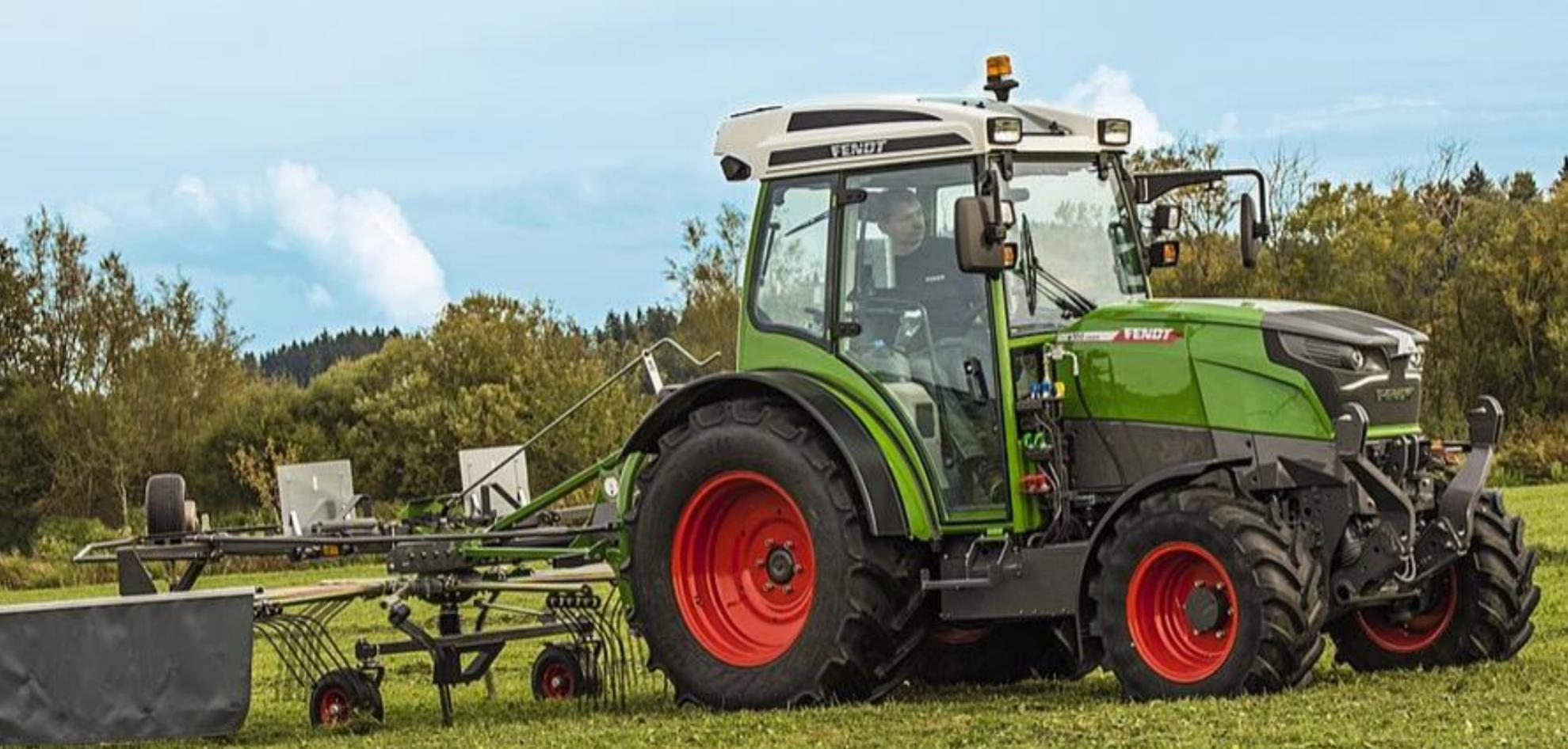
Vollelektrischer Traktor mit 50 kW Leistung. Der Akku hat eine Speicherkapazität von 100 kWh. Laden über CCS mit 50 kW
