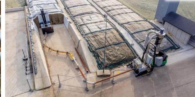
**VARIANTE 2: SAUGZYKLON MIT MOBILEM GRUNDGESTELL IM AUSSENBEREICH**
