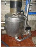
Füllstandsabhängiges Arbeiten der Milchförderpumpe = bessere Milchvorkühlung um 1 bis 2 °C
