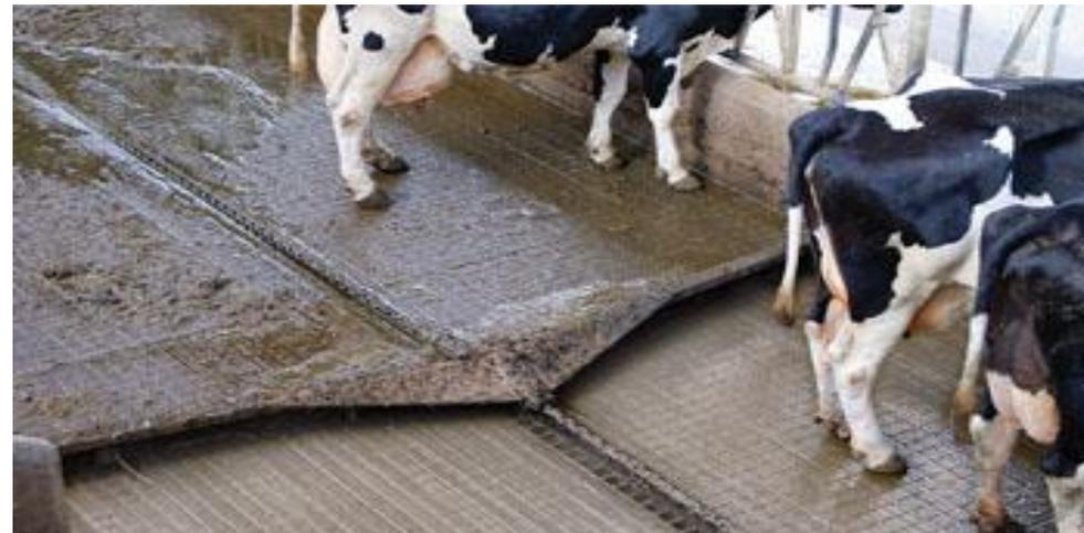
Bodenplatte mit Mistschieber
