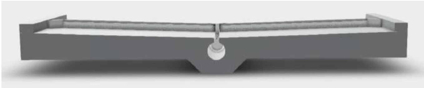
Abb. 19: Planbefestigter Boden mit Quergefälle und Harnsammelrinne (© KTBL)
