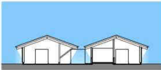
Bauweise mehrhäusiger Stallanlagen mit integriertem, nicht überdachtem Auslauf (aus Simon et al., 2020)
