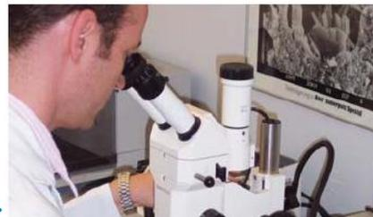
Mikroskopische Untersuchung einer Baustoffprobe
